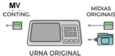
1. Na urna original: desligue e retire a **MV** de contingência se ela estiver dentro da urna. Recoloque as mídias originais da seção.
